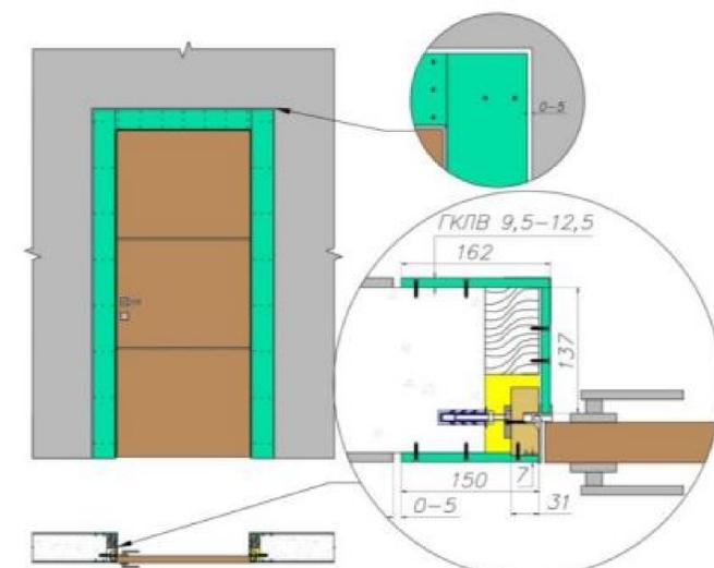
4. Шпаклевка и финишная отделка проема. После облицовки зашпаклюйте стыки гипсовой смесью, во избежание появления трещин вокруг проема рекомендуется наклеить на швы стеклохолст «паутинка», затем вся плоскость шпаклюется. Когда шпаклевка высохнет можно начинать окрашивание стен, либо поклейку обоев.
